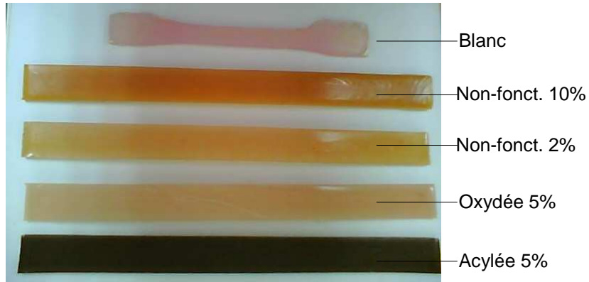
Éprouvettes – \mu -cellulose
