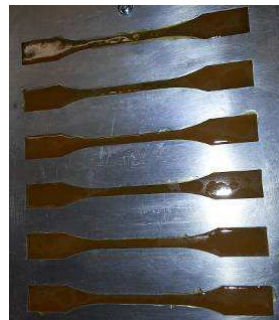
Éprouvettes – \mu -cellulose 10%
