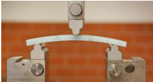
Flexion 3 points sur tuyau (ISO 178)
